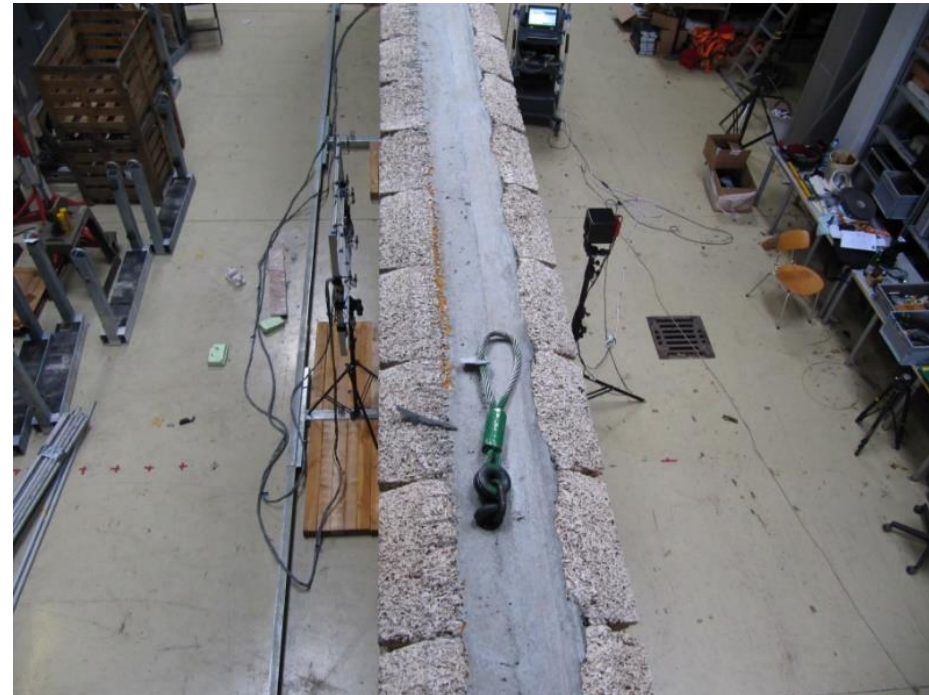
Test setup - airborne sound insulation - acc. to EN 1793-6 or EN 16272-3-2
