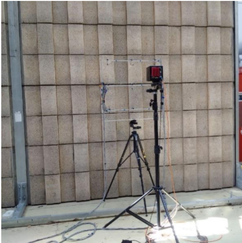
Test setup - sound reflection - acc. to EN 1793-5 or EN 16272-3-2
